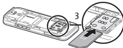
Pastikan daerah kontak berwarna emas pada kartu menghadap ke bawah pada perangkat, dan pojok yang terpotong pada kartu menghadap ke bawah.
