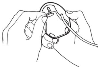
Para cerrar el soporte, pulse el botón situado en el lateral del soporte. Cuando no usa el soporte, puede enrollar el cable USB alrededor de los salientes que hay a ambos lados del soporte.
