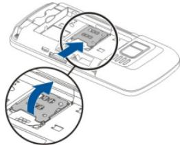
٤ ارفع حامل بطاقة SIM، ثم أدخل بطاقة SIM. تأكد من إمكانية توجيه منطقة التلامس الموجودة بالبطاقة لأسفل عند إنزال حامل بطاقة SIM.
