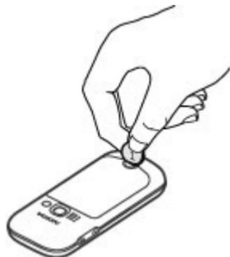
Pour libérer et replacer la façade arrière, tournez la vis à l'aide d'une pièce ou d'un tournevis.
