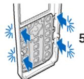
6. Vuelva a colocar la carcasa delantera presionando suavemente contra el teléfono y comenzando desde la parte inferior (6).
