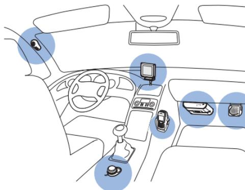
*Ejemplo de instalación correcta con la unidad de pantalla montada con el adhesivo suministrado*
