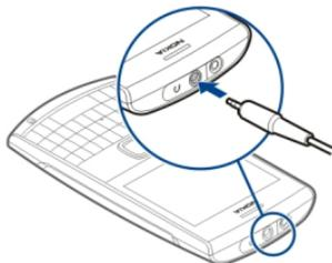
Non collegare prodotti che generano segnali in uscita, in quanto ciò potrebbe danneggiare il dispositivo. Non collegare il Nokia AV Connector ad alcuna fonte di
