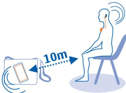
Dieses Gerät entspricht der Bluetooth Spezifikation 2.1 + EDR . Folgende Profile werden unterstützt: Headset (HSP) 1.1, Handsfree (HFP) 1.5 . Erkundigen Sie sich bei den Herstellern anderer Geräte über deren Kompatibilität mit diesem Gerät.
