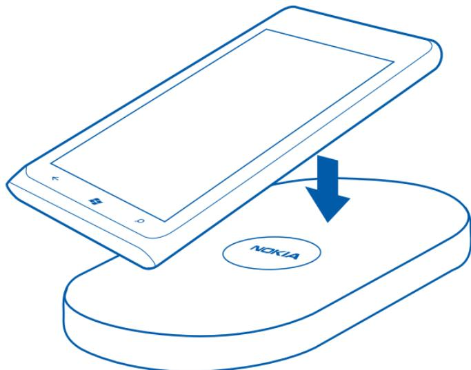
Es normal que la plataforma y el teléfono se calienten, y más aún si utiliza el teléfono para, por ejemplo, transmitir música mientras se está cargando.
