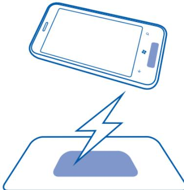
Qi funciona por inducción magnética y actualmente está pensado para dispositivos que utilizan 5 vatios de potencia o menos, como los teléfonos móviles. Los cargadores y los dispositivos Qi utilizan la misma frecuencia, así que mientras sus áreas activas estén en contacto, todos los productos Qi son compatibles, independientemente del fabricante o de la marca que se trate. Para ver más detalles, consulte las guías de usuario de ambos dispositivos.
