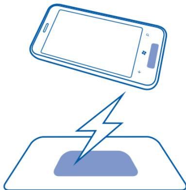
يُعمل Qi باستخدام الحث المغناطيسي، وهو مصمم حاليًا للأجهزة التي تستخدم طاقة بحجم 5 واط أو أقل، مثل الهاتف المحمولة. تستخدم أجهزة شحن Qi والأجهزة التردد ذاته، لذلك فطالما كانت الأماكن النشطة بها ملامسة، فكل منتجات Qi تكون متوفقة، بغض النظر عن المصنع أو العلامة التجارية.
