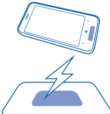
Qi funktioniert mit magnetischer Induktion und ist derzeit für Geräte vorgesehen, die einen maximalen Energiebedarf von 5 Watt aufweisen, z. B. Mobiltelefone. Die Qi-Ladegeräte und -Geräte verwenden dieselbe Frequenz, daher ist jedes Qi-Gerät oder -Ladegerät unabhängig vom Hersteller oder der Marke kompatibel, so lange sich ihre
