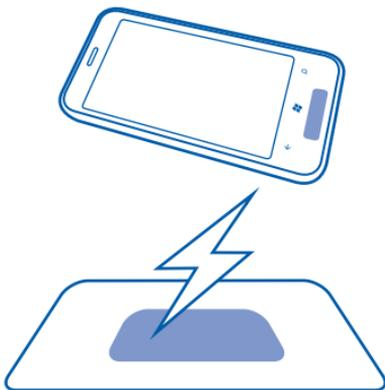
Qi funciona por inducción magnética y actualmente está pensado para dispositivos que utilizan 5 vatios de potencia o menos, como los teléfonos móviles. Los cargadores y los dispositivos Qi utilizan la misma frecuencia, así que mientras sus áreas activas estén en contacto, todos los productos Qi son compatibles, independientemente del fabricante o de la marca que se trate. Para ver más detalles, consulte las guías de usuario de ambos dispositivos.
