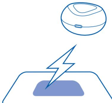
Lo standard Qi si basa su induzione magnetica ed è stato progettato per dispositivi che utilizzano al massimo 5 watt di alimentazione, come i telefoni cellulari. I caricabatterie e i dispositivi Qi utilizzano la stessa frequenza. Pertanto, finché le loro aree attive si toccano, tutti i prodotti Qi sono compatibili, indipendentemente dal produttore o dal marchio. Per maggiori informazioni, consultare i manuali d'uso di entrambi i dispositivi.
