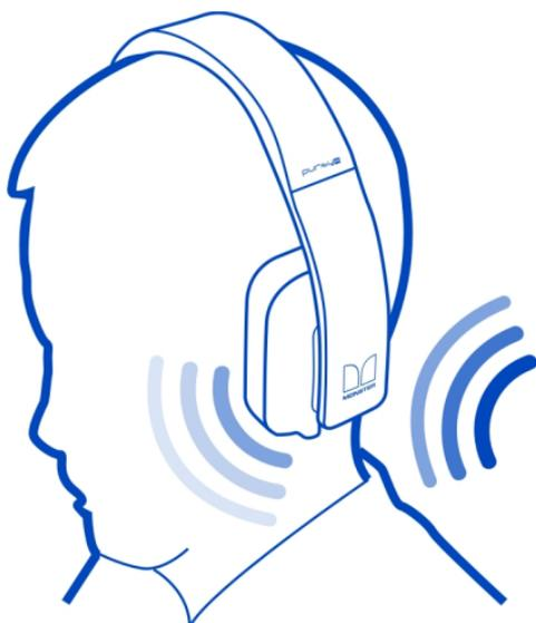
Lorsque vous mettez votre kit oreillette sous tension, les capteurs de proximité de l'écouteur activent automatiquement l'ANC. Lorsque vous retirez le kit oreillette, l'ANC se désactive.
