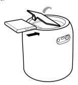
Quando a carga da bateria do altifalante está fraca, o indicador do estado da bateria fica vermelho intermitente. Quando a bateria estiver a carregar, a luz permanece acesa.
