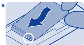
วางแนวหน้าสัมผัสของแบตเตอรี่ แล้วดัน แบตเตอรี่เข้าไป
