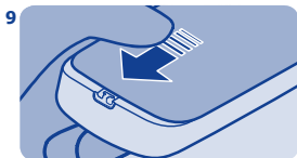
เลื่อนฝาครอบด้านหลังลงจนกระทั่งฝา ครอบล็อกเข้าที่ โปรดดูที่ ➡ 2
