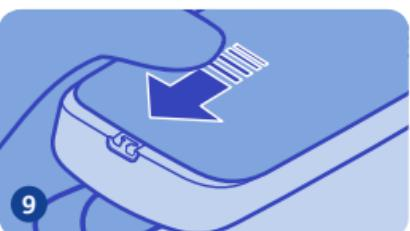
Deslice la carcasa posterior hasta que encaje en su sitio. Véase ➔ 1.
