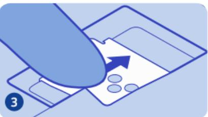
Deslice la tarjeta de memoria hacia la parte superior del teléfono.
