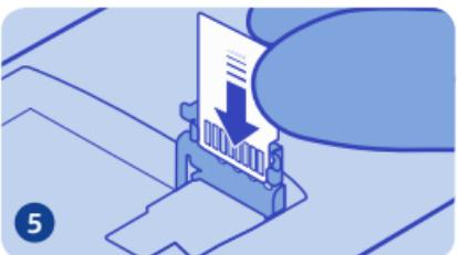
Inserte una tarjeta de memoria compatible con la zona de contacto orientada hacia abajo.
