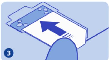
Deslice la SIM bajo el soporte con la zona de contacto orientada hacia abajo. Véase ↗ 2 en "Instrucciones específicas de la función".
