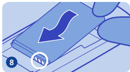
Poravnajte baterijske kontakte, zatim gurnite bateriju unutra.
