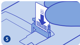
Umetnite kompatibilnu memorijsku karticu s kontaktnom površinom okrenutom prema dolje.
