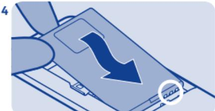
4 Beachten Sie die Anschlusskontakte des Akkus und setzen Sie den Akku ein.
