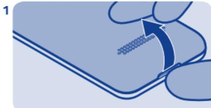
1 Schalten Sie das Mobiltelefon aus und nehmen Sie die rückseitige Abdeckung ab.
