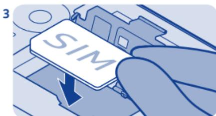
3 Heben Sie den SIM-Kartenhalter an. Setzen Sie SIM-Karte mit dem Kontaktbereich der Karte nach unten weisend ein. Siehe → 3.
