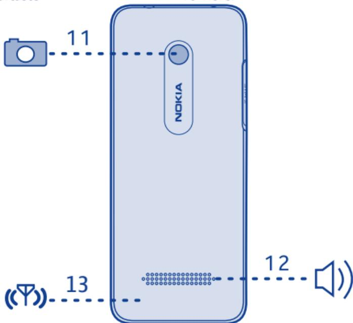
11 Kameraobjektiv. Entfernen Sie vor Verwendung der Kamera die Schutzfolie von der Linse.
