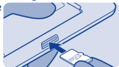
Schieben Sie die Speicherkarte ein, bis sie einrastet. Der Kontaktbereich muss nach unten zeigen.
