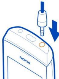
Не подключайте аппаратуру, которая формирует выходной сигнал, поскольку в результате устройство может оказаться повреждено. Не подключайте источники напряжения к разъему AV Nokia. При подключении к разъему AV внешнего устройства или минигарнитуры, отличных от рекомендованных для данного устройства, уделите особое внимание уровню громкости.
