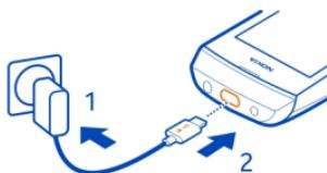
Если отсутствуют электрические розетки, для зарядки устройства можно использовать USB-кабель. Во время зарядки устройства можно передавать данные. Эффективность зарядки через USB-кабель значительно ниже. Кроме того, процесс зарядки, достаточной для запуска и начала работы устройства, может занять продолжительное время.
