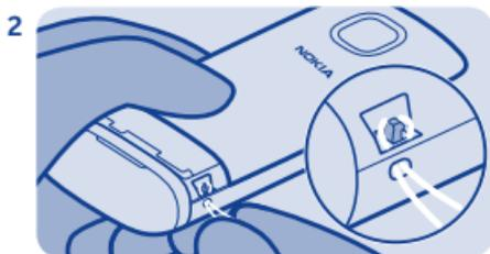
Insérez la boucle dans l'orifice, puis faites-la passer par-dessus le crochet.
