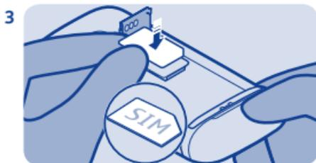
Faites glisser le logement et soulevez-le. Insérez la carte SIM avec la zone de contact orientée vers le bas. Voir ➡ 1.
