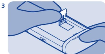
Faites glisser le logement et soulevez-le. Insérez la carte avec la zone de contact orientée vers le bas.
