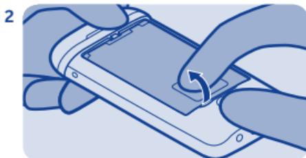
Si la batterie est insérée dans le téléphone, soulevez-la pour la retirer.
