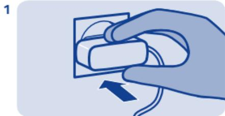
1 Collegare il caricabatteria a una presa a muro.
