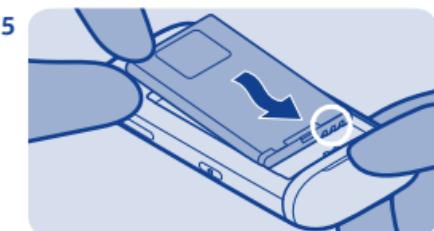
Savienojiet akumulatora kontaktus un pēc tam ievietojiet akumulatoru.
