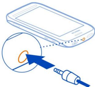
Schließen Sie keine Produkte an, die ein Ausgangssignal erzeugen, da das Gerät dadurch beschädigt werden kann. Schließen Sie keine Spannungsquelle an den Nokia AV-Anschluss an. Achten Sie besonders auf die Einstellung der Lautstärke, wenn Sie ein externes Gerät oder Headset, das nicht von Nokia für die Verwendung mit diesem Gerät zugelassen wurde, an den Nokia AV-Anschluss anschließen.
