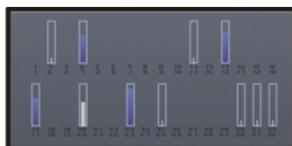
Hat Ihr Gerät Satelliten gefunden, wird für jeden gefundenen Satelliten ein Balken in der Ansicht der Satelliteninfo angezeigt. Je länger der Balken ist, desto stärker ist das Signal des Satelliten. Wenn Ihr Gerät über das Satellitensignal genügend Daten zur Berechnung Ihres Standorts empfangen hat, ändert sich die Farbe des Balkens.
