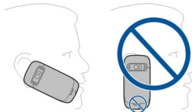
Um eine optimale Geräuschunterdrückung zu erzielen, halten Sie das Mobiltelefon mit dem Hörer an Ihr Ohr und das Hauptmikrofon an Ihren Mund. Verdecken Sie nicht das Zusatzmikrofon auf der Rückseite des Mobiltelefons.
