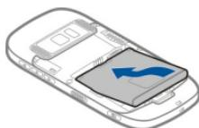
5 若要裝回背面外殼，請將上方的固定鉤對準凹槽，然後向下按壓直到外殼卡入定位為止。
